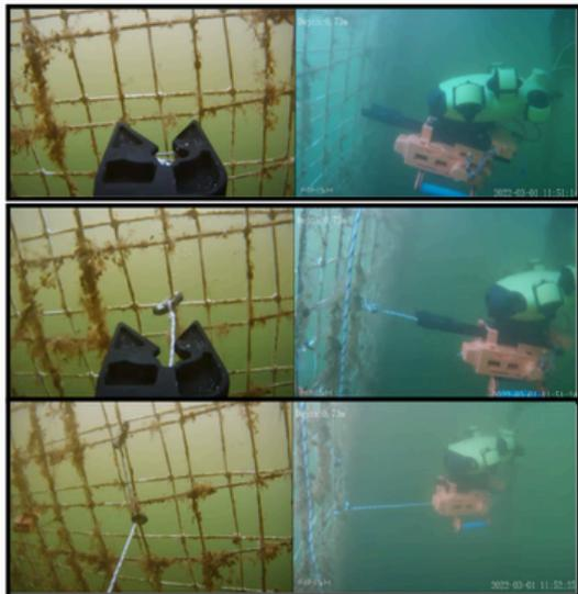
Imagen: ROV en reparación de red con técnica de mosquetones.
