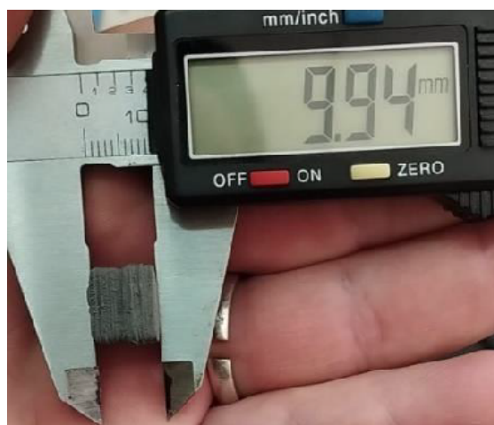
Figura 13: Medición de altura de la décima iteración de impresión de cubos. (Elaboración propia)
