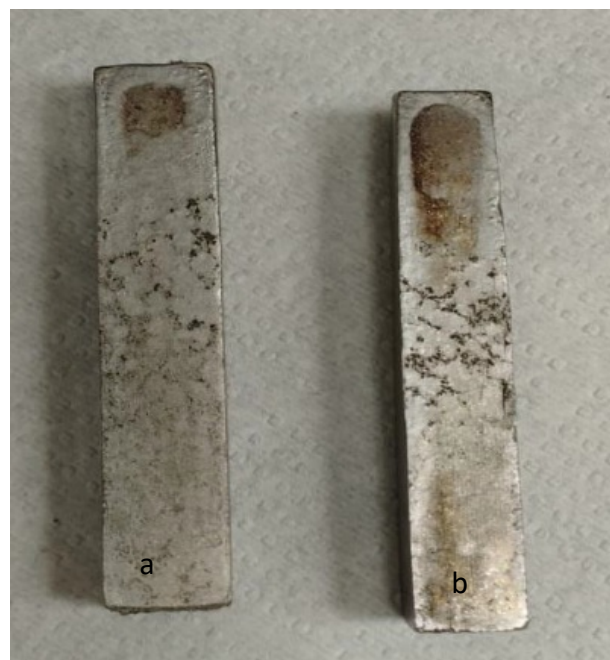
Figura 18: Fotografía de probetas de impacto recién sinterizadas. (Elaboración propia)
