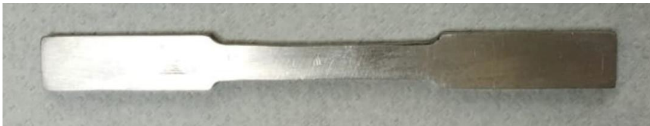
Figura 19: Probeta de tracción pulida y preparada para efectuar ensayo de tracción. (Elaboración propia)
