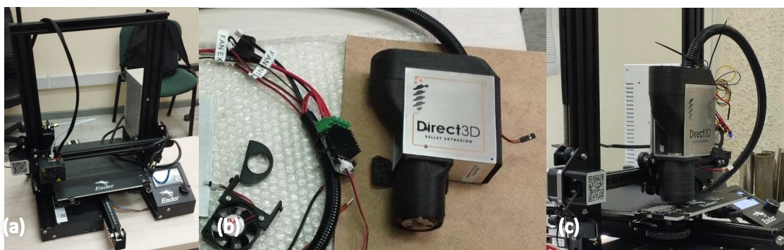
Figura 11: Fotografía de la impresora Ender 3 (a), extrusor de pellets instalado (b) y su montaje (c). (Elaboración propia)
